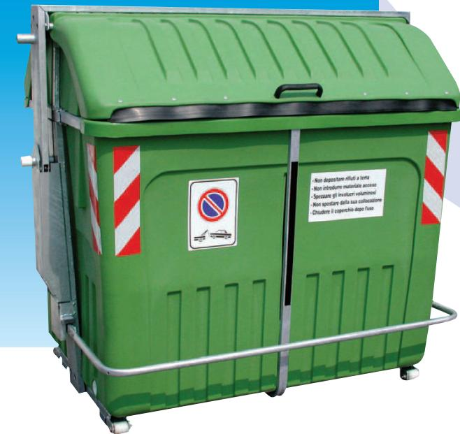
**Materiale e stampaggio.** Prodotti in polietilene lineare riciclabile con la tecnica dello stampaggio rotazionale, realizzati in un pezzo unico, senza giunzioni né saldature.
