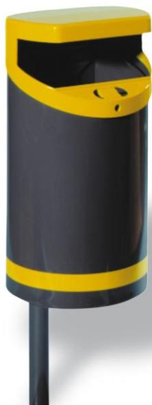
Il cestino a palo ECO 50 è realizzato in robusta lamiera d'acciaio zincata con coperchio presso fuso in lega leggera d'alluminio, predisposto per il fissaggio a palo mediante apposito dispositivo di aggancio.
