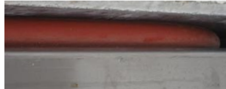
Guarnizione gonfiabile per tenuta stagna.
