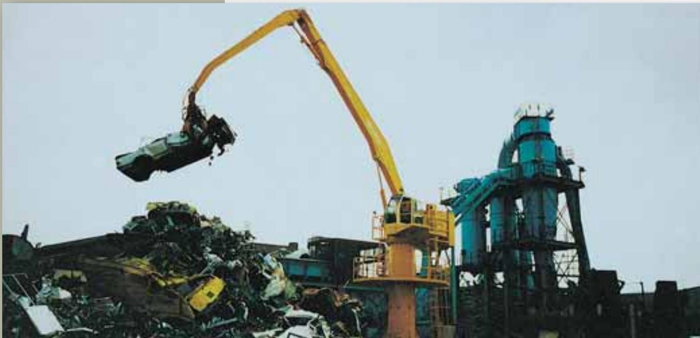
Gru fisse con funzionamento elettrico o diesel, con comandi sulla torretta girevole servo-assistiti. E' possibile trasferire nella cabina della gru anche i comandi per l'azionamento della cesoia, della pressa, del mulino.
