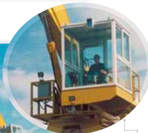
Gru fisse con doppi comandi elettro-idraulici proporzionali sia sulla torretta girevole, sia a distanza nella cabina della cesoia, della pressa, del mulino.
