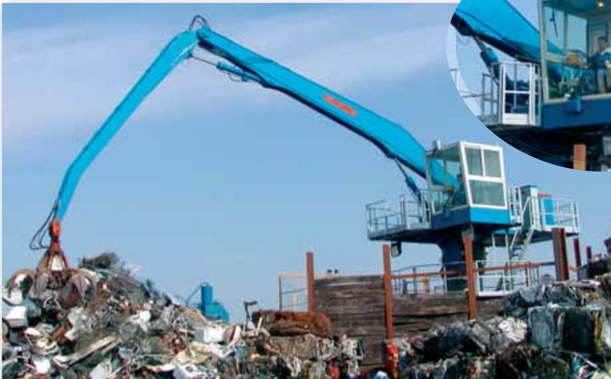
Gru fisse con funzionamento elettrico o diesel, con comandi sulla torretta girevole servo-assistiti per alimentazione mulini fino a 4500 CV.
