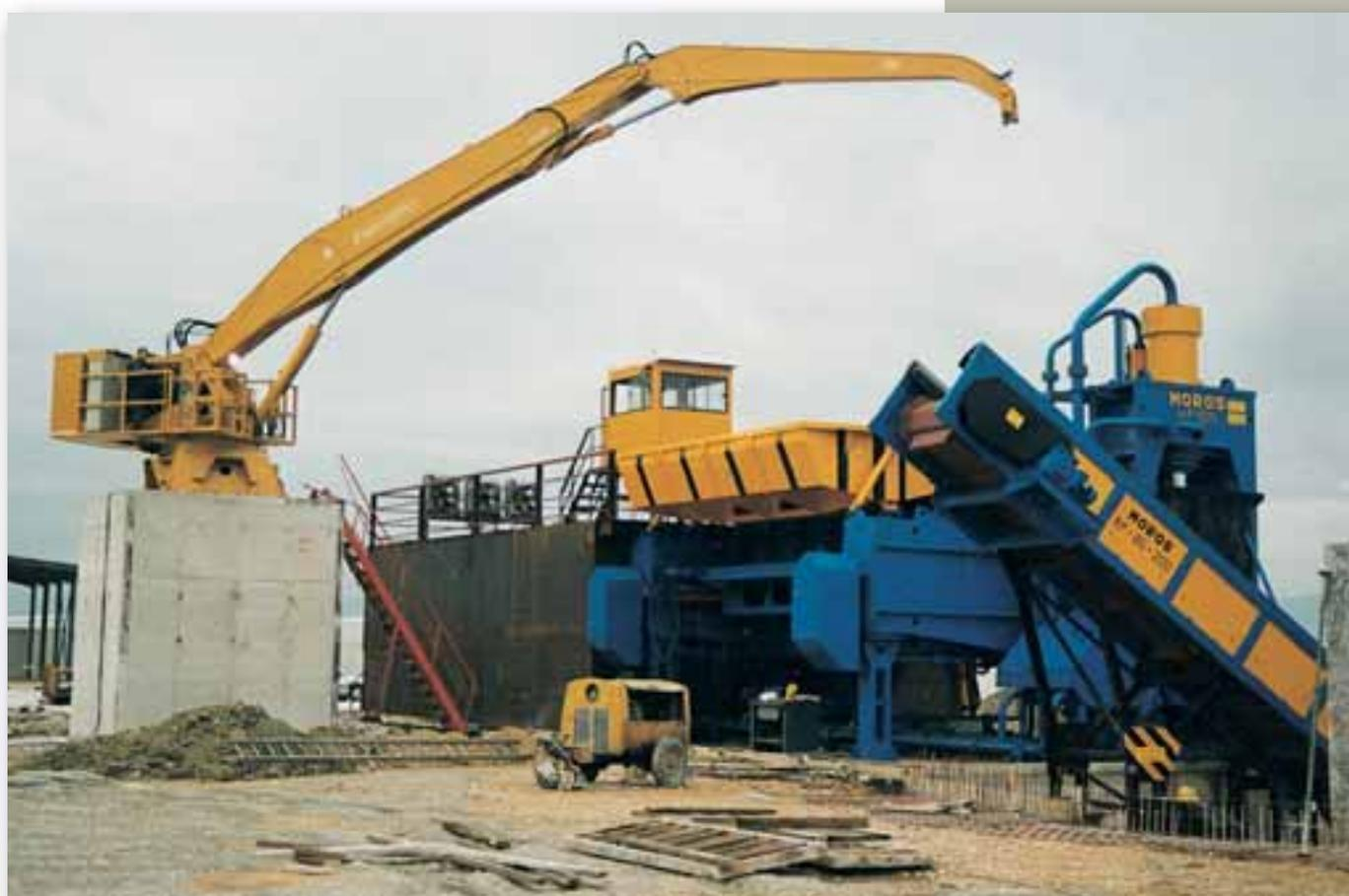
Gru fisse con comandi a distanza, elettro-idraulici proporzionali, posizionati nella cabina della cesoia o della pressa.
