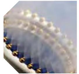
Particolare della bocca del cannone con evidenziate le due corone di ugelli nebulizzanti in azione.
