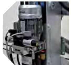
Particolare del gruppo pneumatico del braccio idraulico.
